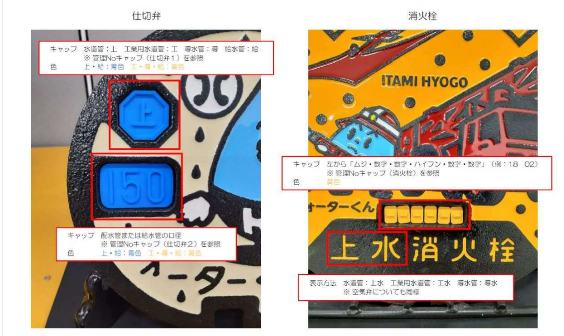
図2-7 弁栓類の新デザイン鉄蓋に関する管理Noキャップ等の明示について
