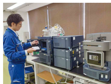
▲LC-MS/MS(液体クロマトグラフ質量分析計)による有機フッ素化合物の測定
